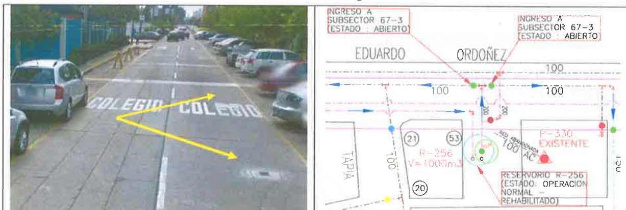
Ilustración 7. Apertura de válvulas de ingreso al subsector 67-3
