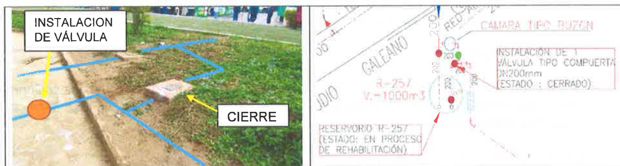
Ilustración 1. Instalación de válvula compuerta DN200mm
